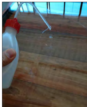
8) Applicare i profili sprossen o il telaio prima dell'evaporazione dell'alcol dalla superficie del vetro. Esercitare un'adeguata pressione per fare aderire correttamente il biadesivo al vetro
